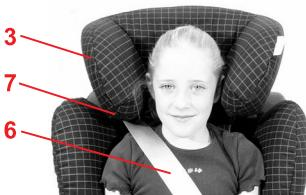
Правильно подогнанный подголовник **3** способствует оптимальному наложению диагонального ремня безопасности **6**, и обеспечивает ребенку надлежащую защиту и желаемое удобство при сидении. Высота подголовника **3** может быть отрегулирована в любом из одиннадцати фиксируемых положений.
