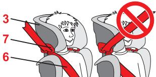
☞ Führen Sie den Diagonalgurt **6** in den dunkelroten Gurthalter **7** der Kopfstütze **3** ein, bis er vollständig und unverdreht im Gurthalter **7** liegt.
