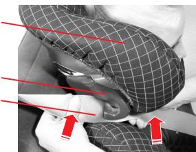
☞ Pase el cinturón diagonal **6** por el soporte de color rojo oscuro **7** del reposacabezas **3**, hasta que se deslice por detrás de la lengüeta de bloqueo **7**.
