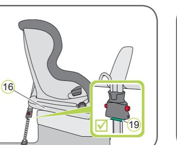
6. Trykk inn begge justeringsknappene 18 og trekk ut støttebenet 17 til det står støtt mot gulvet i bilen. Indikatoren på støttebenet 19 må være helt grønn.
